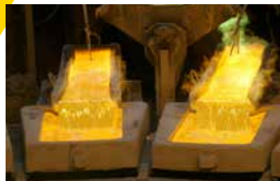
La fundición forma parte del proceso de purificación del cobre, y se realiza en hornos especiales y a muy altas temperaturas. El cobre es moldeado en placas o ánodos, que luego pasan a otro proceso llamado electrorrefinación.
