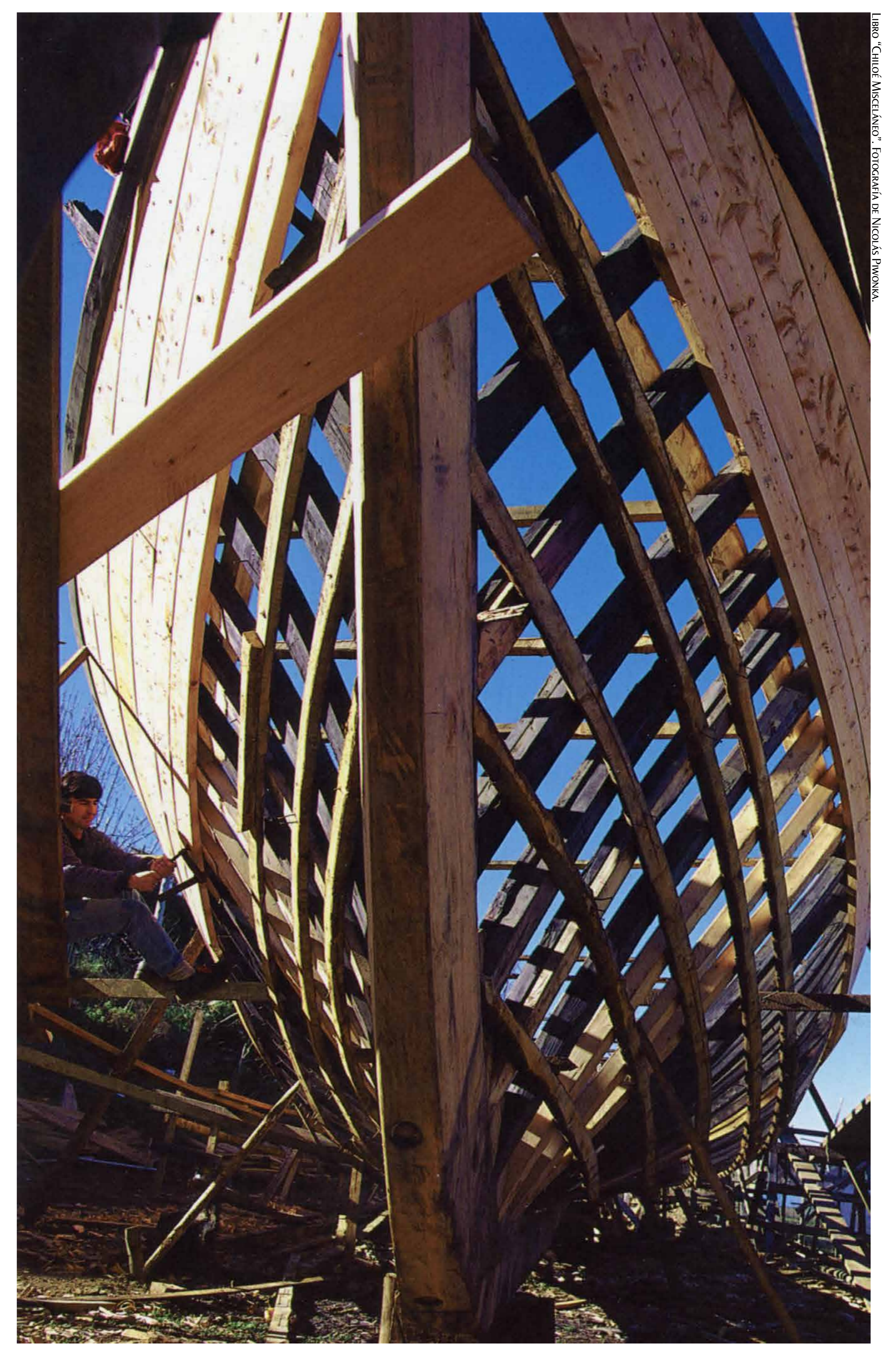
Con coigüe, los carpinteros arman la estructura de la embarcación: la quilla, el codaje y el cuadernaje; mientras el entablado completo lo hacen de ciprés. Entre cinco y siete meses tardan en construir una lancha pesquera o de turismo.
