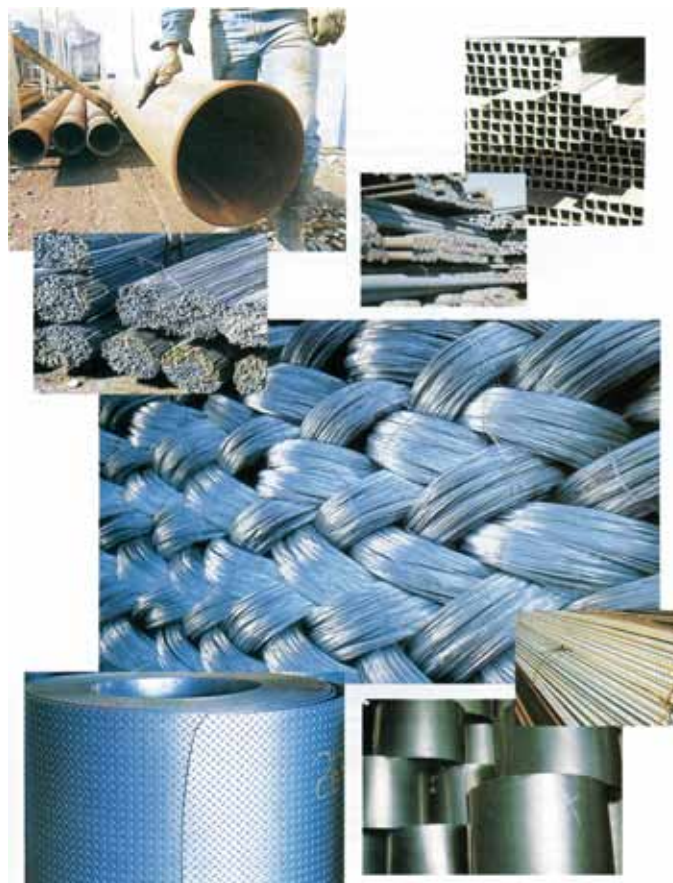
Estos productos se obtienen después que el acero pasa por un proceso que incluye la desulfurización, la conversión al oxígeno y la laminación.
