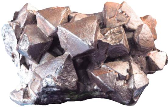
Este mineral tiene propiedades magnéticas, y se encuentra en forma natural en rocas de origen ígneo y sedimentario. Junto con la hematita, estos óxidos de minerales contienen casi un 70% de hierro. Y -cuando se combina el hierro con carbono- se obtiene acero. El acero se utiliza para la construcción de buques de guerra, rascacielos y cohetes espaciales.
