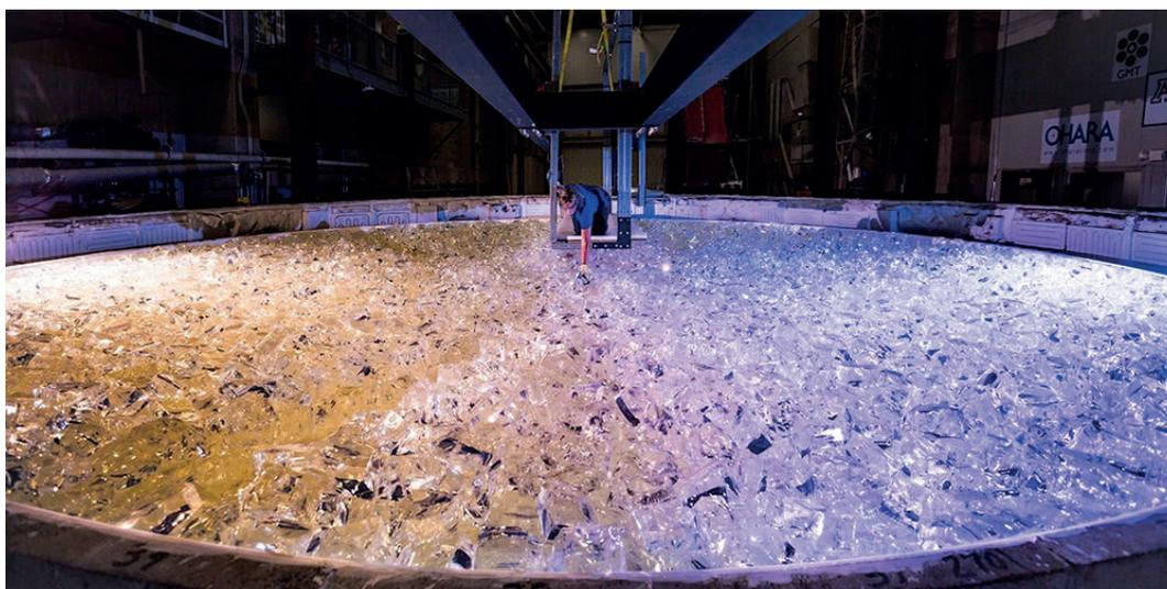
Construcción del segmento 5 del espejo primario del Telescopio Gigante de Magallanes en ATACAMA.
